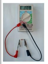
Si la résistance est utilisée dans un montage, il faut l'en extraire avant de la connecter à l'ohmmètre.
